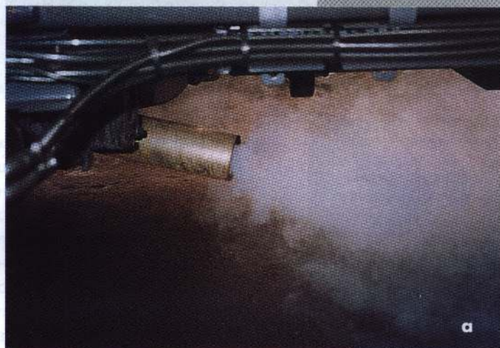
Отсекатель белого дыма не только уменьшает дымность, но и позволяет быстрее прогреть двигатель: а) отсекаТЕЛЬ выключен; б) отсекаТЕЛЬ включен.
