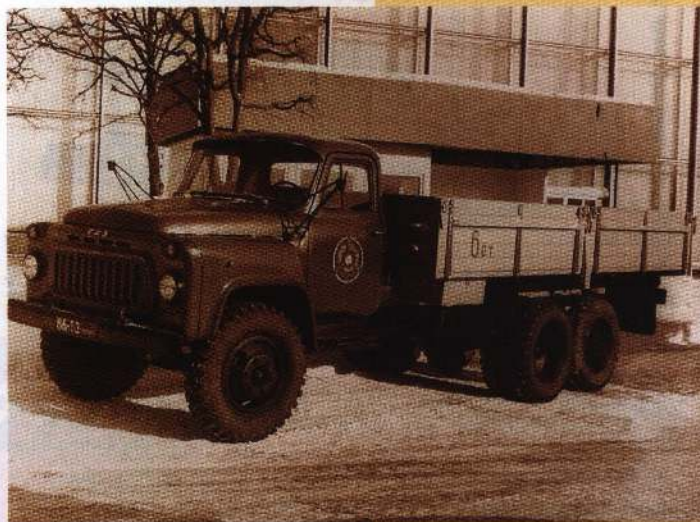
В 1968 году в НИИАТе был разработан грузовик «ГАЗ-53А» с третьей поддерживающей осью, которая могла подниматься при пороженных рейсах, что увеличило грузоподъемность до 6 тонн, однако дальше двух опытных образцов дело не пошло. Фото автора
