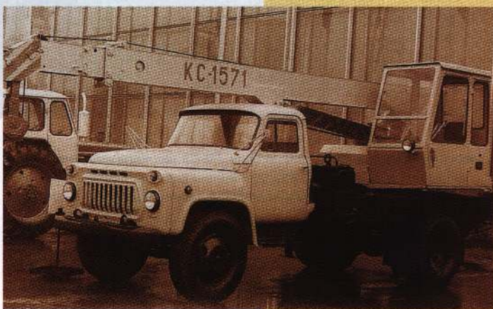
Гидравлический автомобильный кран «КС-1571», смонтированный на шасси «ГАЗ-53А», был незаменим на строительстве небольших сельских домов, особенно в республиках Советской Прибалтики. Такие краны изготавливал с 1975 по 1990 год Ставропольский завод автомобильных кранов. Фото автора
