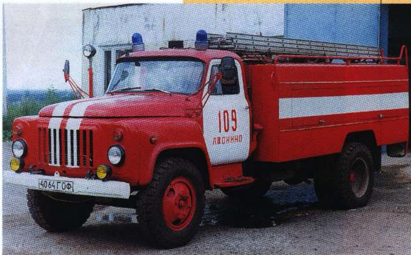
Пожарный автомобиль комбинированного тушения «АКТ-05» модели 207 на шасси «ГАЗ-53-12» строился с 1984 по 1990 год Варгашинским заводом противопожарного оборудования. Фото Владимира Новоселова
