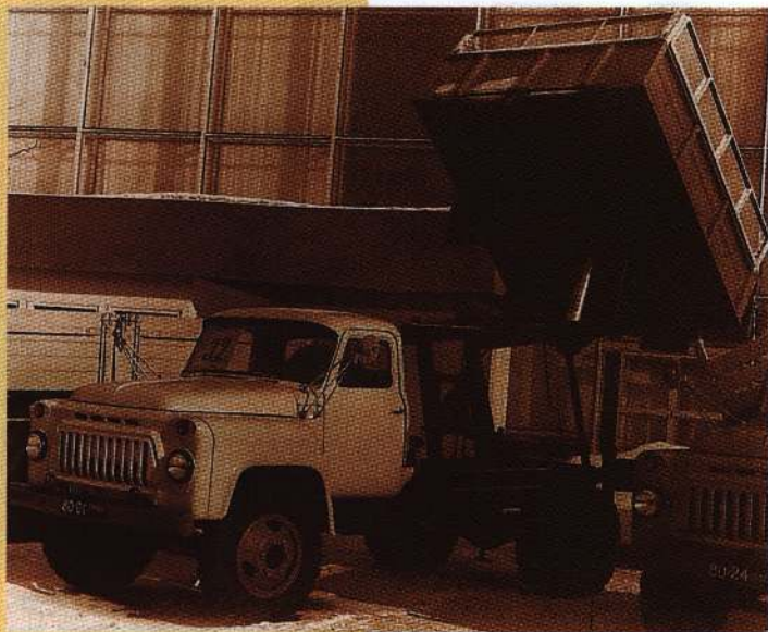
Сельскохозяйственный автосамосвал «ГАЗ-53-3502» с предварительным подъемом кузова строился Саранским заводом автосамосвалов и был незаменим при загрузке бункеров комбайнов. Фото автора
